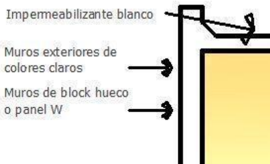
Fig. 4 Características exteriores de la vivienda
