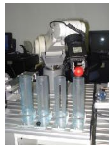
Fig. 13. El Brazo se mueve hacia el contenedor adecuado para el color de la pelota para depositarla en el.
