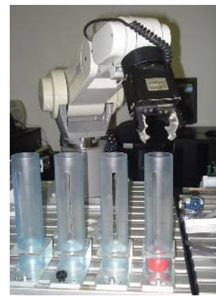
Fig. 9. Tres imágenes (IM1, IM2 e IM3) del proceso de clasificación de pelotas por color, enlazando la rutina desarrollada con el brazo de robot RVM1.
