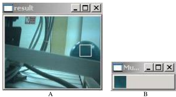
Fig. 4. A) Pelota roja en la zona de procesamiento con la región de interés marcada. B) Imagen Muestra de la región de interés. C) Histograma del plano R de la imagen Muestra.
