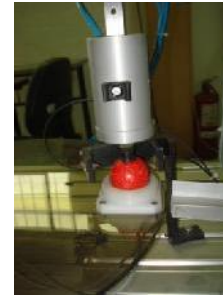
Fig. 6. El brazo Pick&Place se coloca para tomar la pelota
