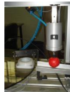
Fig. 7. El brazo Pick&Place mueve la pelota de lugar
