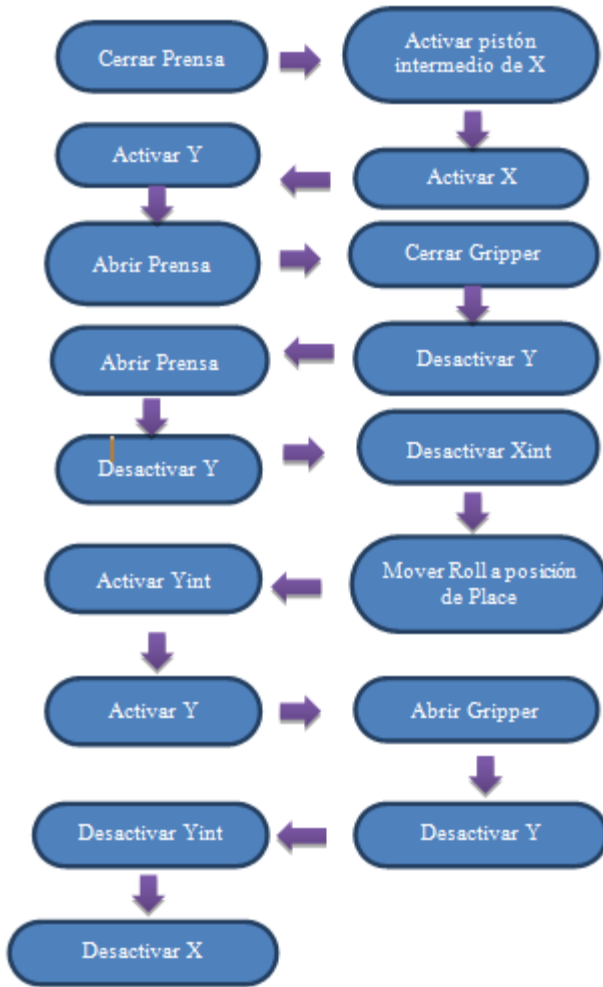
Diagrama 1.-Algoritmo para control de la estación de estampación
